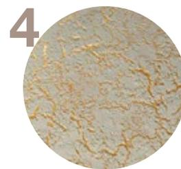
4 Трещины образуются при высыхании верхнего слоя покрытия.
